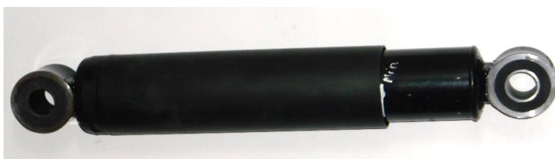
RYСУNEK 1. Obiekty badań: a) amortyzator hydrauliczny, b) model numeryczny w programie LMS Amesim
